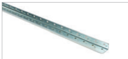
Winkelschiene 4 mm, 120, 150, 180 und 240 cm oder nach Wunsch, mit 6 mm Löchern im Abstand von 5 cm
